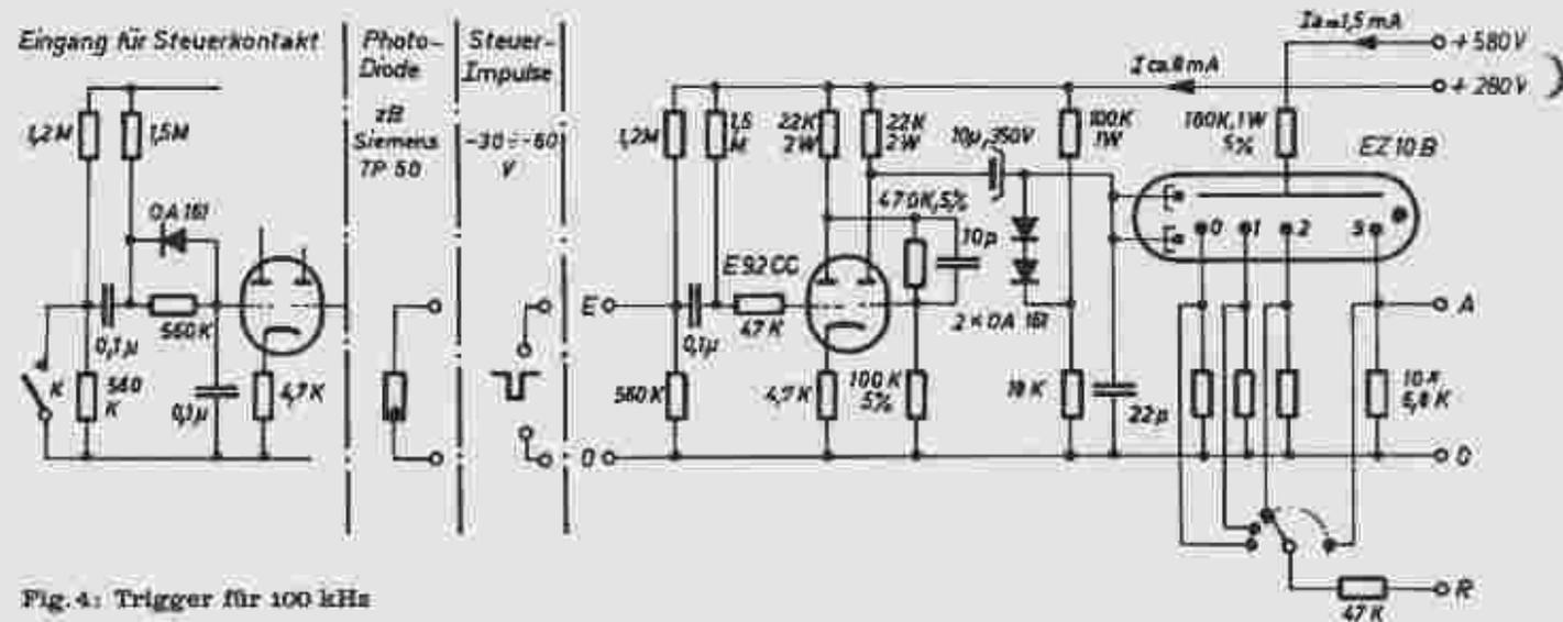
Fig. 4: Trigger für 100 kHz
