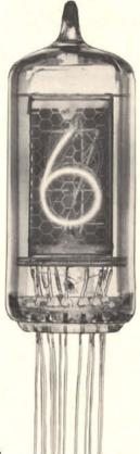
Bei der ZM 1020 beträgt die Ziffernhöhe 15,5 mm, die Ziffernbreite 10 mm; bei der ZM 1080 beträgt die Ziffernhöhe 13 mm, die Ziffernbreite 8 mm. Während in der ZM 1020 die Ziffernebenen senkrecht zur Röhrenachse liegen, liegen sie in der ZM 1080 parallel zur Röhrenachse. Beide Röhren sind zur Kontrastverbesserung mit einem Farbfilterüberzug versehen. Auf diese Weise kann der Einfluß der inneren Raumhelligkeit, die sich sonst störend bemerkbar machen würde, unterdrückt werden.
