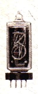
SIEMENS-Ziffernanzeigeröhre ZM 1334, mit rotem Farbfilterüberzug, Anzeigeziffern 0-9 m. Dezimalpunkt links u. rechts, Ziffernhöhe 13,1 mm, besonders für TTL-Ansteuerung geeignet (auch Röhren- u. Schalteransteuerung), sehr konturenscharfe Anzeige.
